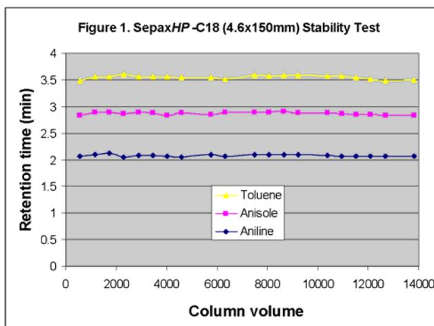
如此高的稳定性使其非常适合于许多分析物的确认。HP-C18 所采用的单层官能团化学键合技术可避免形成复合的 C18 分子层。具备这种均匀涂层的固定相具有高选择性和高分离效率的特点。图 2 是对 4.6×150mm HP-C18 柱进行测试得到的色谱图。
