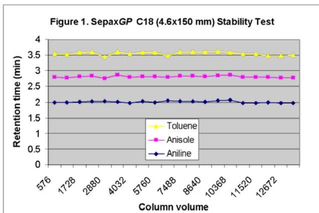
GP-C18 如此高的稳定性使其非常适合于许多分析物的确认。GP-C18 所采用的单层官能团化学键合技术可避免形成复合的 C18 分子层。具备这种均匀涂层的固定相具有高选择性和高分离效率的特点。图 2 是 4.6×250mm GP-C18 柱上进行测试得到的色谱图。
