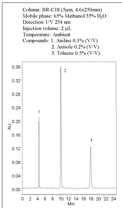
图 2 BR-C18 柱的质量检测图谱
