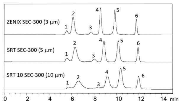
图 2. 蛋白混合物分离图谱，色谱柱规格为 7.8 x 300 mm，在 1 mL/min 流速下分析，紫外波长 214 nm。色谱峰分别为 (1) 甲状腺球蛋白聚集体，(2) 甲状腺球蛋白，(3) 牛血清白蛋白二聚体，(4) 牛血清白蛋白，(5) 核糖核酸酶 A，(6) 尿嘧啶。
