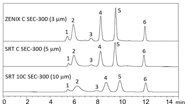
图 3. 蛋白混合物分离图谱，色谱柱规格为 7.8 x 300 mm，在 1 mL/min 流速下分析，紫外波长 214 nm。色谱峰分别为 (1) 甲状腺球蛋白聚集体，(2) 甲状腺球蛋白，(3) 牛血清白蛋白二聚体，(4) 牛血清白蛋白，(5) 核糖核酸酶 A，(6) 尿嘧啶。
